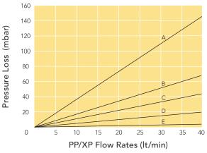
A=0.5μm B=1μm C=3/5μm D=XP/10-50μm E=70/90μm
