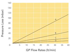
A=0.5µm B=1.0µm C=3/5µm D=10µm+
