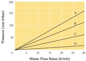
A= 1.0 μm B=3/5 μm C=10/20 μm D=30 μm+
