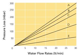
A= 0.3/0.5 μm B=1.0 μm C=3 μm D=5 μm E=10/20 μm
